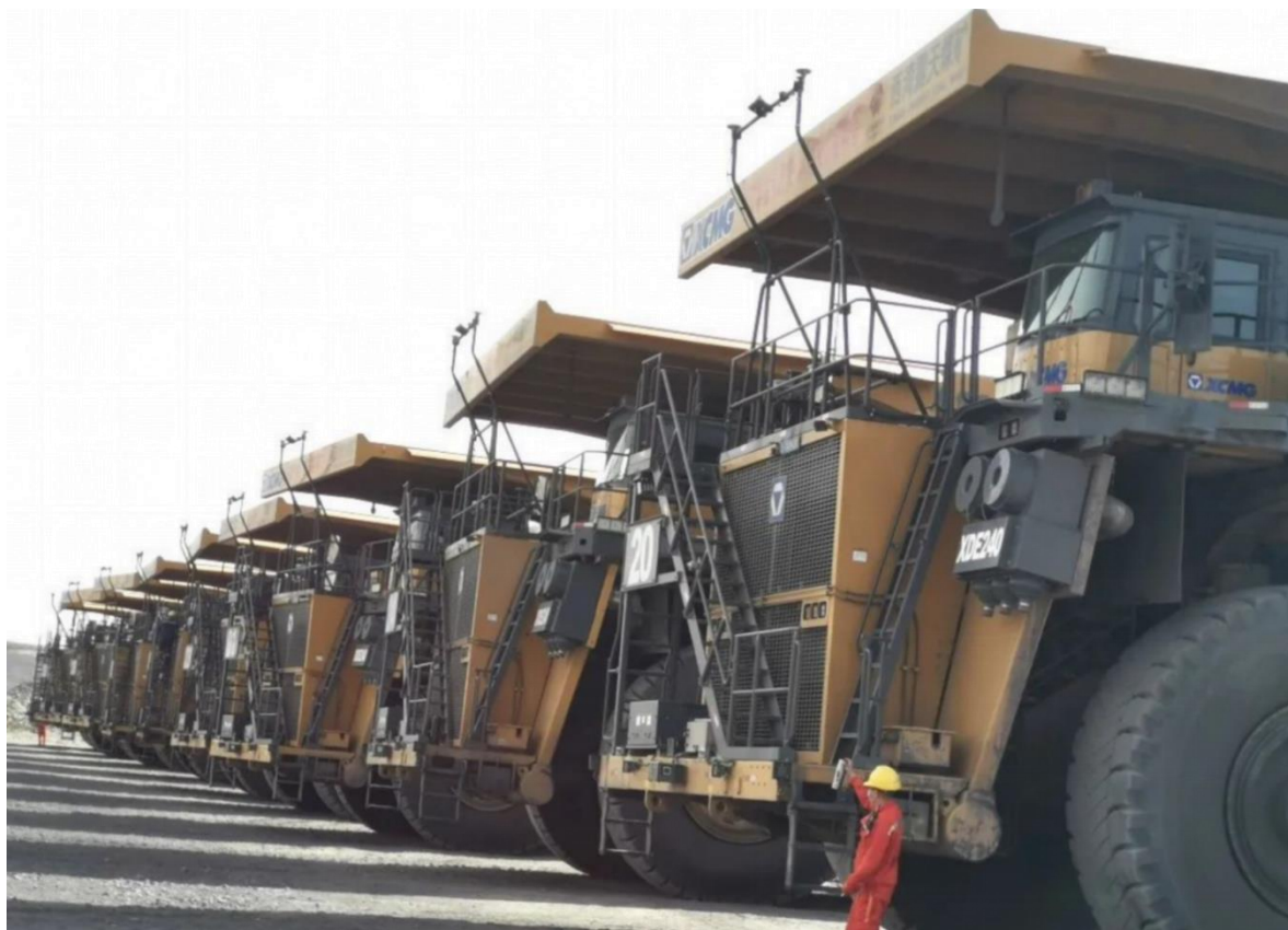
西湾露天矿卡项目实现矿用卡车“装-运-卸”全流程无人驾驶和辅助车辆的协同作业
