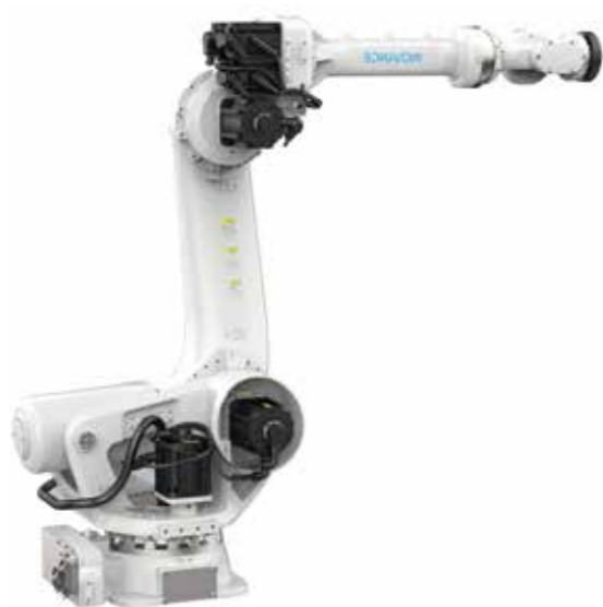
2023新品发布:IR-R220系列六关节机器人,最大负载220kg
