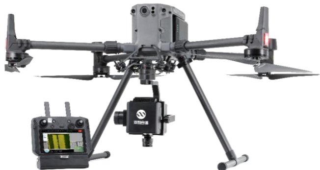
典型的无人机高光谱成像检测系统
