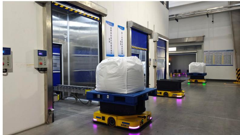
潜叉式自动导引车（AGV）小车
